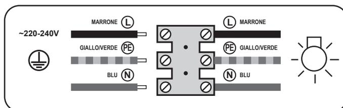
Per questo tipo di collegamento utilizzare una morsettiere (non fornita in dotazione) provvista di tre connettori in ingresso e tre in uscita.
