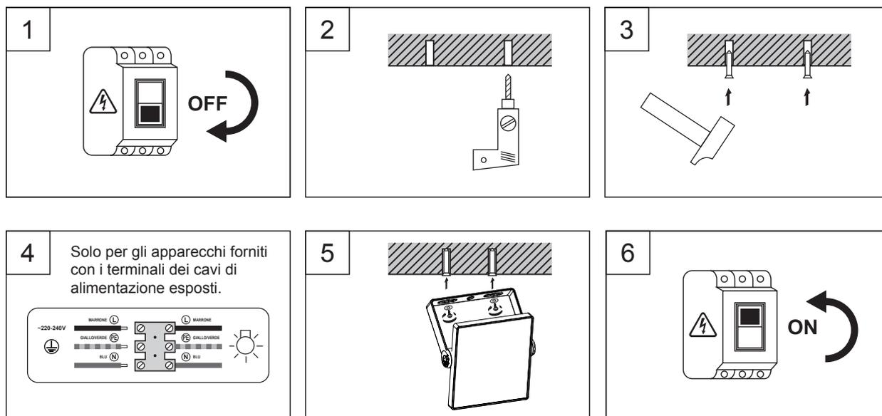
Qualora l'apparecchio venisse fornito con i terminali dei cavi di alimentazione "esposti", ossia senza la spina di connessione, eseguire il collegamento dei terminali al cavo di alimentazione secondo questo schema:
